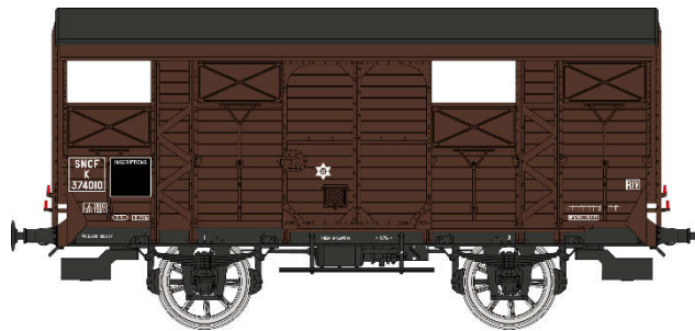
Réf. WB - 702 - Wagon COUVERT PLM 20 T brun wagon 540, N° K 374010 avec renforts de caisse en Z, SNCF Ep.III B.
