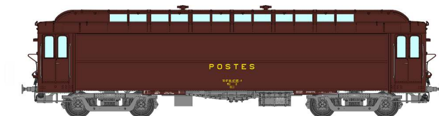
VB-254 – Allège OCEM 16m Transformation Allemande PEZ brun PTT, châssis gris, bogie Y2, N° 50 87 00-47 915-4 Ep.IV
