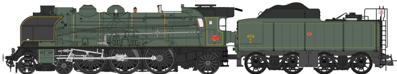
Machine 2-231 K 16 SNCF CALAIS - cheminée double, grands écrans fumée, pompe Bi-Compound, ACFI, tender 30m 3 , machine et tender Vert, filets jaunes, porte de boîte à fumée Nord, Plaque FLECHE d'OR.
