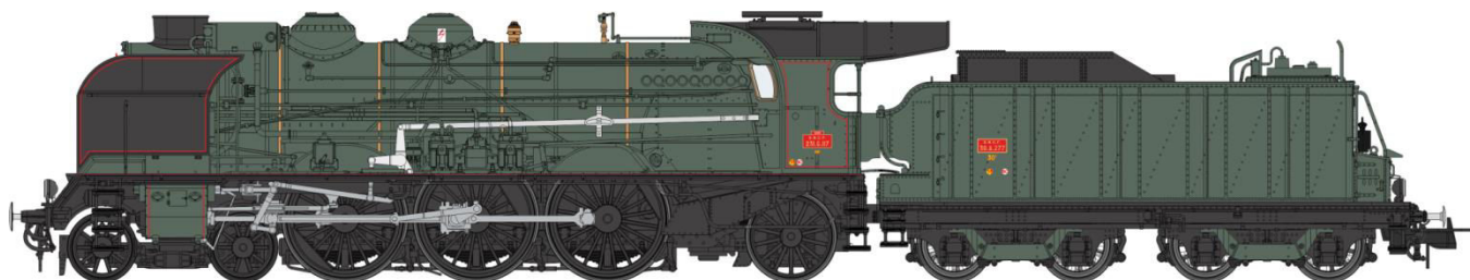
Machine 3-231 G 117 SNCF TOURS - Toit allongé, cheminée double, grands écrans fumée, pompe Bi-Compound, ACFI, tender 30m 3 hotte bois, Vert SNCF filets uniquement sur la machine.
