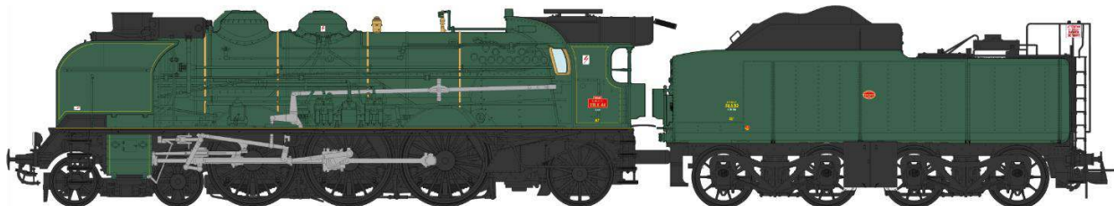
Machine 2-231 K 44 Calais cheminée double, grands écrans pare-fumée, pompe Bi-Compound, ACFI, tender 38m 3 , machine et tender Vert, filets jaunes.
