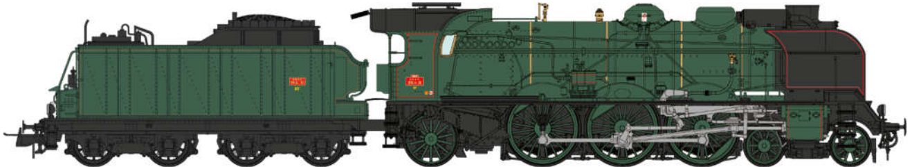
Machine 5-231 H 21 Nevers - cheminée double, grands écrans pare-fumée, pompe Bi-Compound, ACFI, tender 30m 3 , machine et tender Vert, filets rouges.
