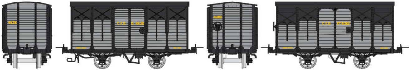
VM-026 - Set de 2 COUVERTS freinés, Toit Rond et Toit 2 pentes, Ferrures Noires Kv 4638 et Kifv 4082
