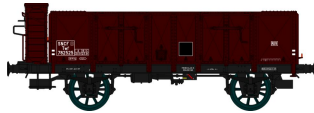
Réf. WB-176 - Wagon TOMBEREAUX OCEM 29 Ep.III W-010-C-03 Wagon Type A Tôle, guérite, boîtes d'essieux à coussinets, roues à rayons N° 782525
